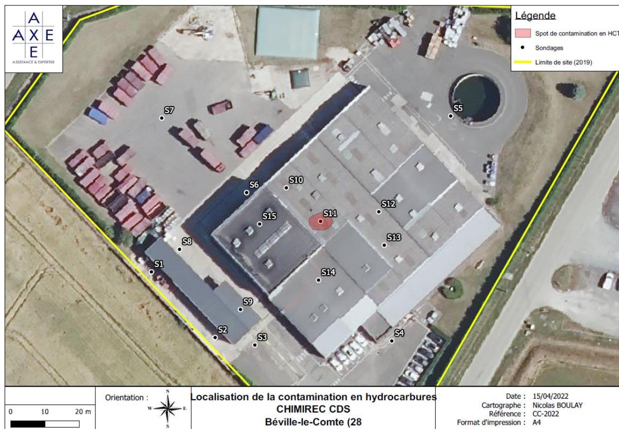
Figure 6 : Localisation de la contamination en hydrocarbures
